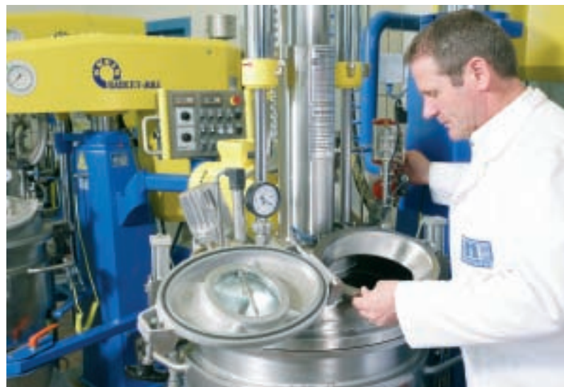
Dissolver eignen sich zum Mischen, Benetzen und Lösen von zähflüssigen Produkten und Pasten.
